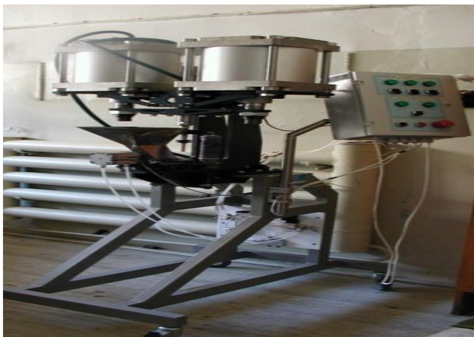
Рисунок 3.6 - Внешний вид автомата таблетирования «АП-01/8»
