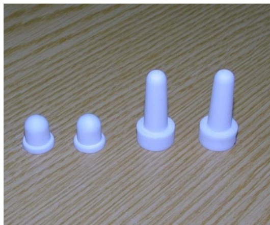
Рисунок 1.21 - Керамические чувствительные элементы датчиков ТДА кислорода капсульного типа
