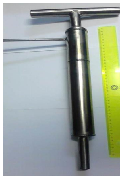
Рисунок 3.37 - Схема и внешний вид МА конвективного типа для стенда «УПСТ»
