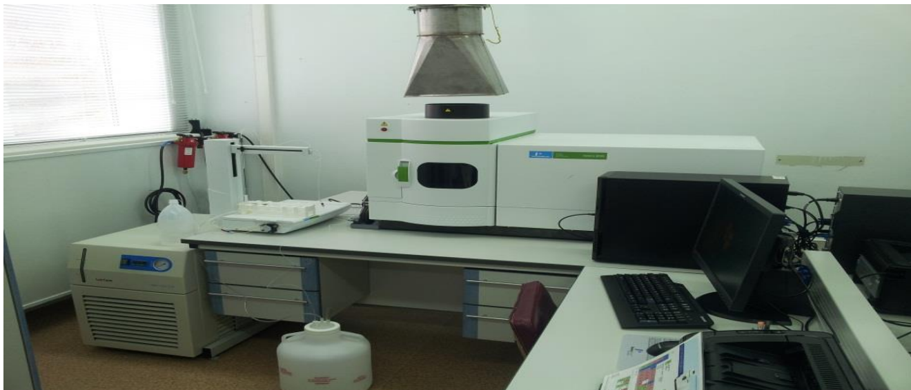
Рисунок 3.5 - Атомно-эмиссионный спектрометр с индуктивно связанной плазмой «Optima 8000»
