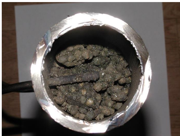
Рисунок 3.46 - Вид поперечного среза верхней части РЕ массообменного аппарата «МА-02-01» и извлеченные сфероиды (после кампании на стенде «СМ-2» ~ 5500 ч)
