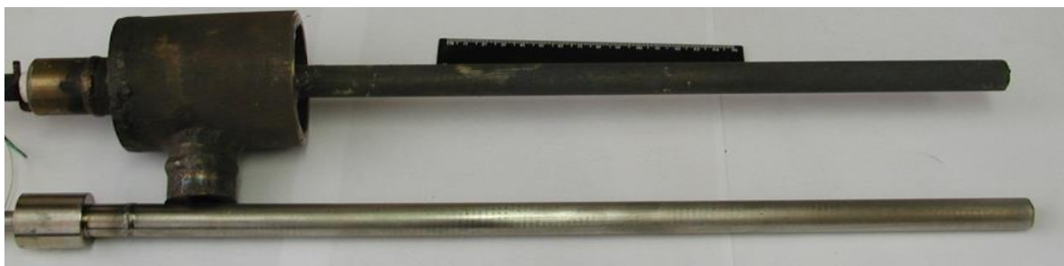
Рисунок 3.51 - Внешний вид внутреннего нагревателя МА нового типа до и после испытаний
