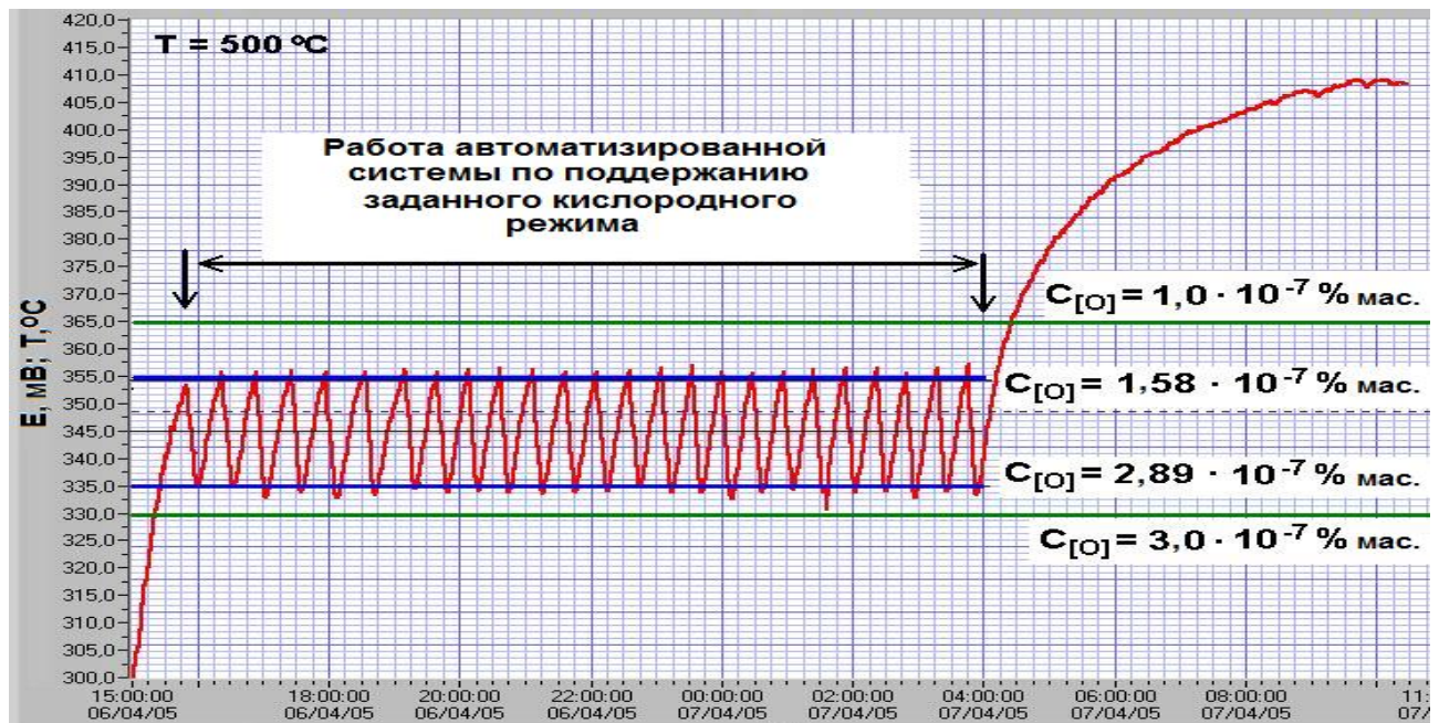
Рисунок 3.17 - Поддержание заданного кислородного режима в статической установке ГНЦ РФ – ФЭИ с помощью МА-ГЛН (2005 г.)
