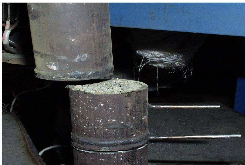
Рисунок 3.42 - Разрез реакционной емкости МА типа «МА-1»
