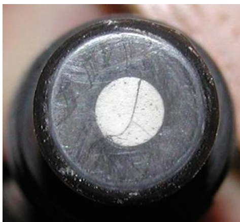
Рисунок 1.19 - Трещина в керамическом чувствительном элементе датчика для циркуляционных контуров
