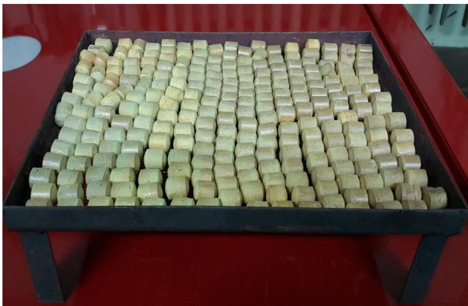
Рисунок 3.8 - Внешний вид контейнера для спекания (до установки в печь)
