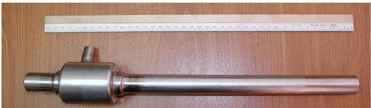
Рисунок 1.28 - Принципиальная схема эжектирования газа в циркуляционный контур с ТЖМТ и внешний вид эжектора
