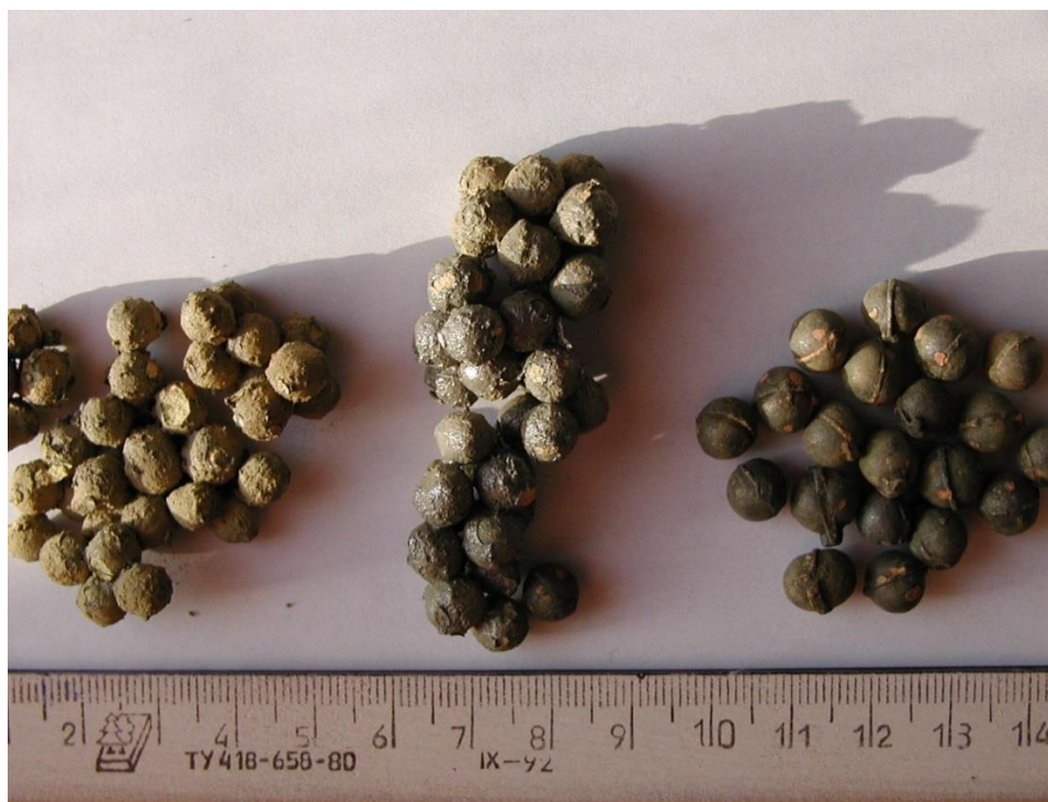
Рисунок 3.44 - Сфероиды оксида свинца (слева-направо: из верхней части и из нижней части РЕ массообменного аппарата «МА-1» (после 1016 ч отработки в свинце при t = 420 - 500\text{ }^{\circ}\text{C} ), исходные (промытые в свинце))
