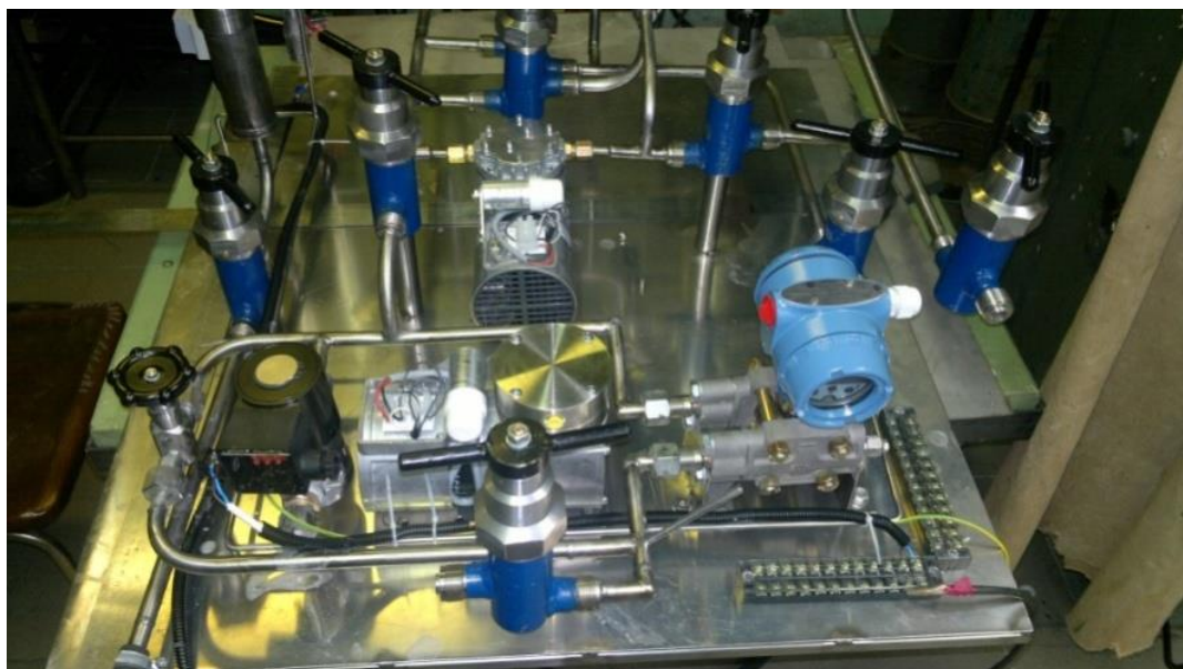
Рисунок 3.79 - Фотография газового контура СТСТ стенда «ЭУСТ» (для колонки испытаний макетов ТВС и ИМ СУЗ)
