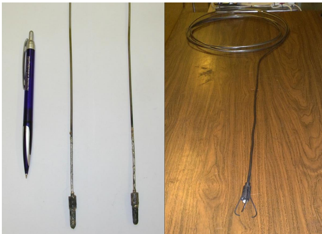
Рисунок 1.23 - Датчик ТДА кислорода для малогабаритных установок (слева), с возможностью погружения до 9 метров (справа)
