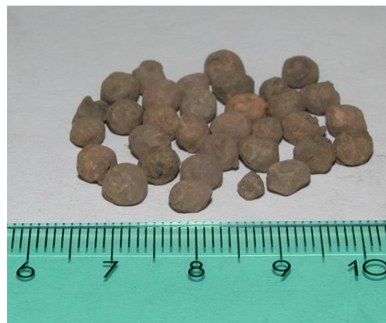
Рисунок 3.46 - Вид поперечного среза верхней части РЕ массообменного аппарата «МА-02-01» и извлеченные сфероиды (после кампании на стенде «СМ-2» ~ 5500 ч)
