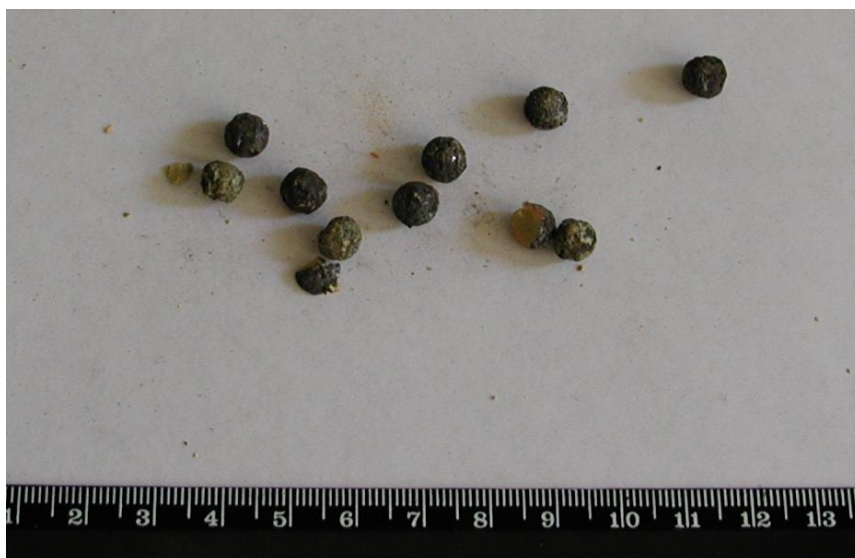
Рисунок 2.11 - Внешний вид гранул PbO после окончания одной из кампаний (кампания №4)
