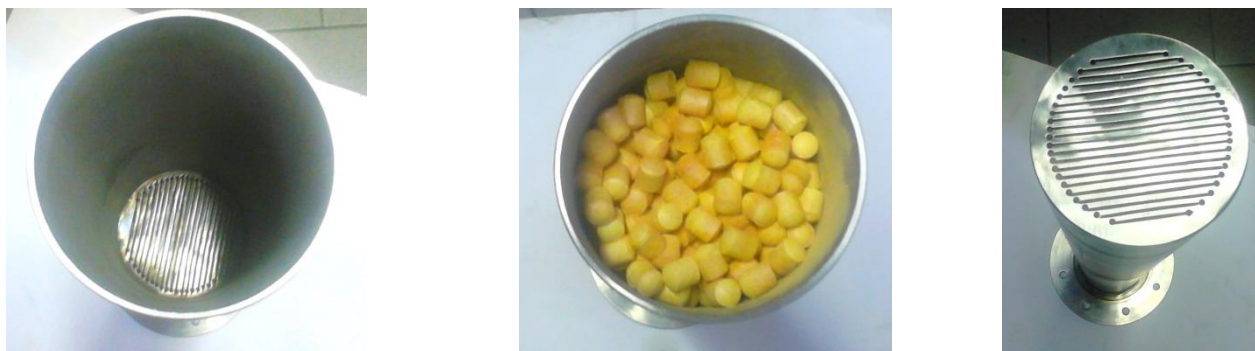
Рисунок 3.84 - Внешний вид на реакционную емкость МА стенда «ФТ-4» (слева направо: пустая (видна верхняя решетка); емкость, заполненная гранулами PbO; нижняя решетка после полной сборки)
