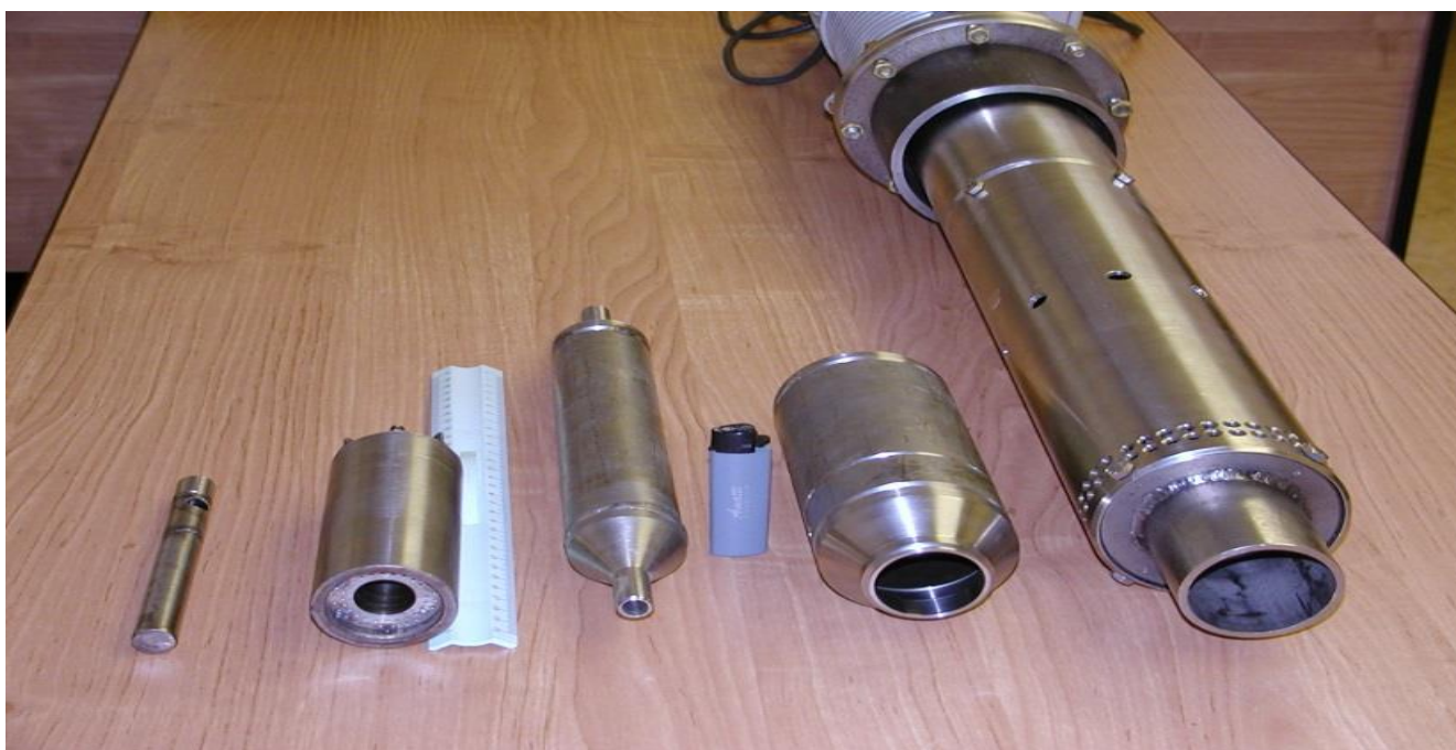
Рисунок 3.1 - Виды конструкций массообменных аппаратов, прошедших испытания на циркуляционных стендах и статических установках в ГНЦ РФ - ФЭИ, ЦНИИ КМ «Прометей», НИКИЭТ
