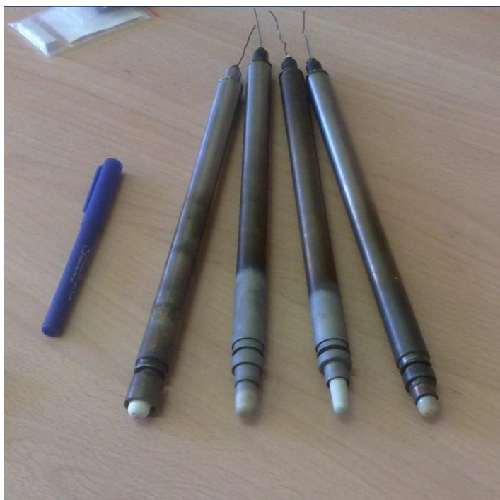
Рисунок 1.22 - Датчик активности кислорода капсульного типа (внешний вид нескольких вариантов исполнения)
