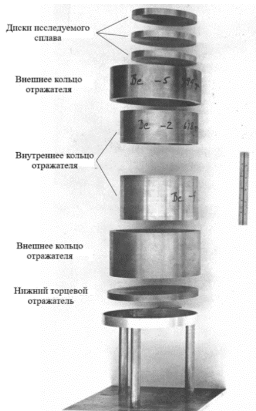
Рисунок 2.3 – Типовая геометрия однодьюмового отражателя (HEU-MET-FAST-084) [37]
