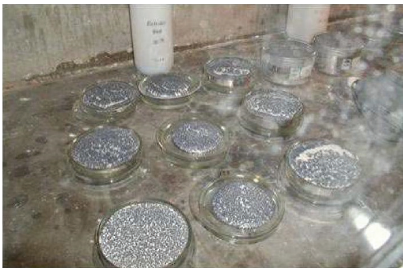
Рис. 18. Образцы NaK при испытаниях процесса карбонизации на быстром реакторе Dounreay
