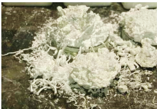
Рис. 19. Образцы продуктов реакции эвтектического и реакторного сплавов NaK
