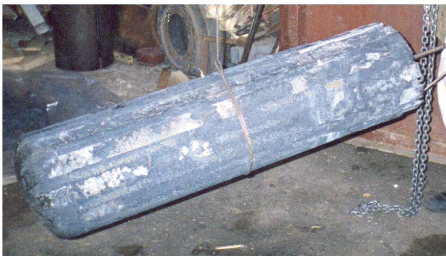
Рис. 25. Продукт переработки 30 литров NaK на установке Минерал-30 (стальной реакционный контейнер удален)
