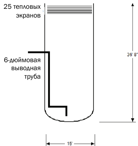
Рис. 7. Контур испытаний композитных реакторных материалов (CRCTA) при отработке технологий отмывки для компонентов реактора FFTF
