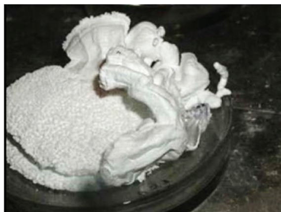
Рис. 19. Образцы продуктов реакции эвтектического и реакторного сплавов NaK
