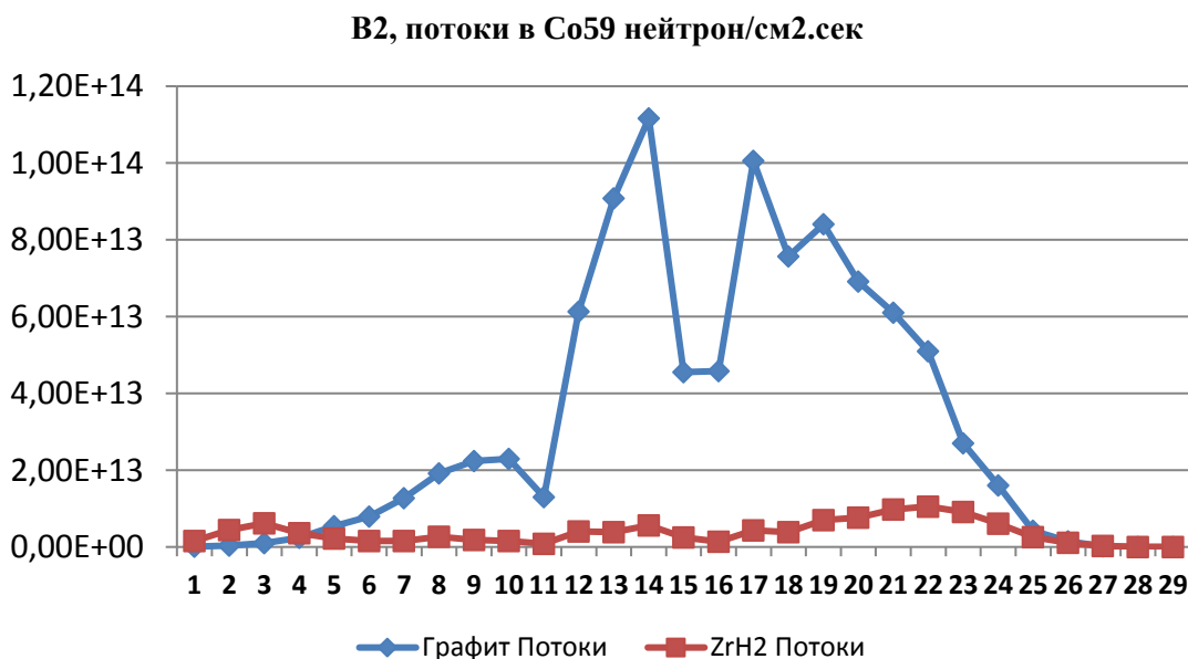
Рис. 9. Плотности нейтронных потоков в Со-59 для варианта В2
