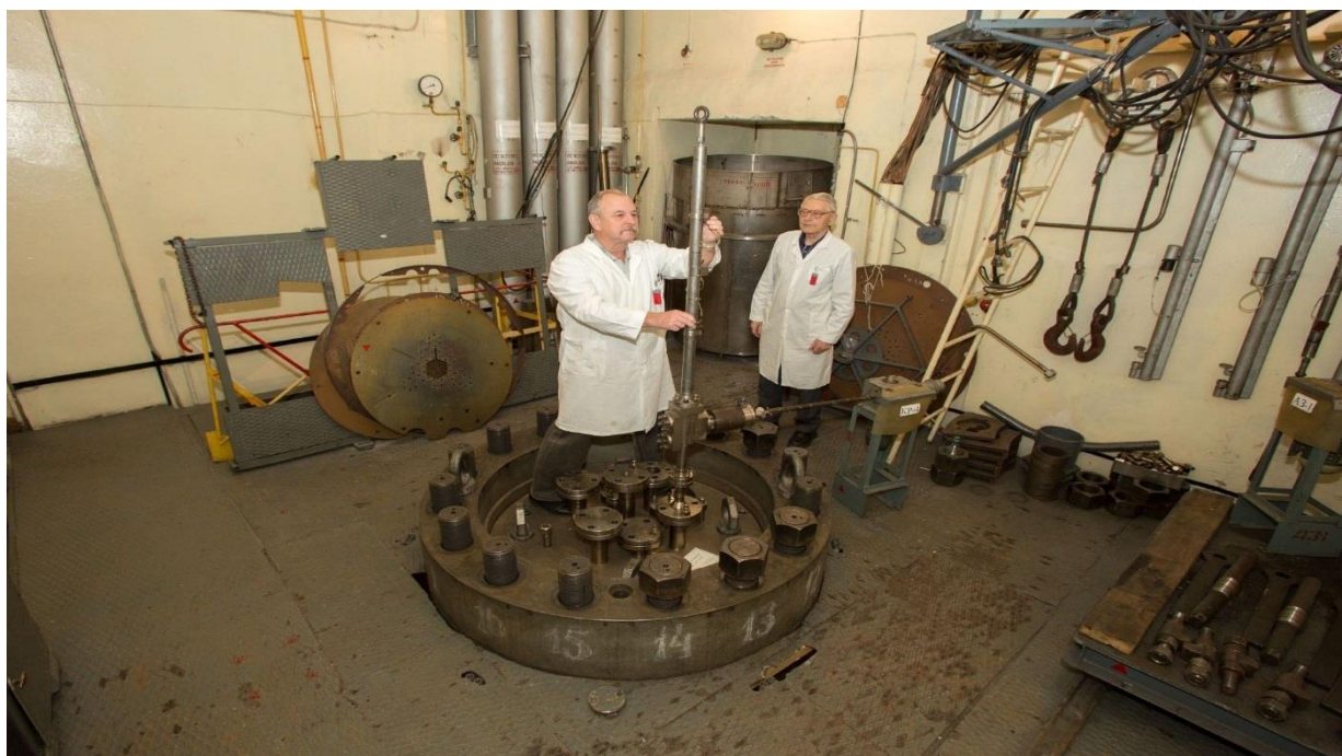
Помещение бокса критстенда на отм. 0,000. Крышка критсборки
